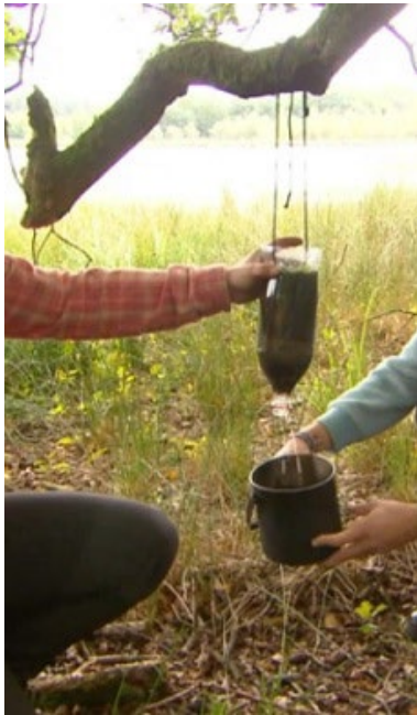
Figuur 42 Zelf een waterfilter maken
